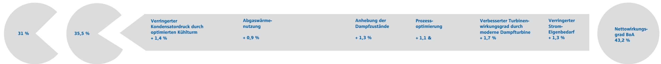
Jahr 1957 Durchschnittlicher Netto-Wirkungsgrad eines 150-MW-Blocks Jahr 1976 Durchschnittlicher Netto-Wirkungsgrad eines 600-MW-Blocks
